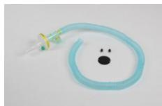
Utilisés avec l'adaptateur spiromètre ( 524056 ), l'adaptateur O 2 ( 524052 ) et l'électrode de mesure de l'oxygène ( 667458 ), les accessoires servent à étudier la consommation d'oxygène.
