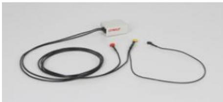
Pour la mesure monocanal de l'activité électrique du coeur (ECG ou électrocardiogramme) ou des muscles (EMG ou électromyogramme) avec le Sensor-CASSY ou le Pocket-CASSY. Les contractions musculaires sont saisies par des électrodes d'argent/de chlorure d'argent autocollantes. Les capteurs sont isolés galvaniquement de CASSY. Se connecte à un marteau réflexe avec déclencheur ( 529491 ).
