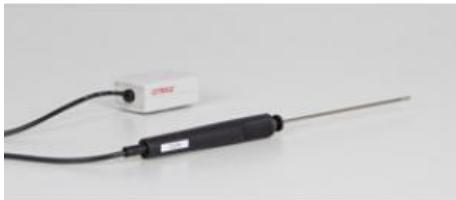
Se branche directement à CASSY ( 524013 , 524006 , 524005 , 524018 ) ou aux instruments de mesure universels Physique, Chimie, Biologie ( 531835 , 531836 , 531837 ) avec sonde de température CTN dans tube en acier inoxydable.
