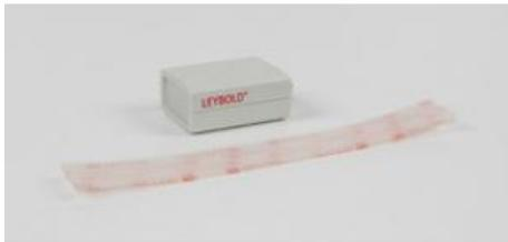
Capteur pour relever les forces g (accélération et gravitation terrestre) agissant sur le capteur avec Sensor-CASSY 2, Mobile-CASSY, Pocket-CASSY 2 ( 524013 , 524005W , 524018 ) ou l'instrument de mesure universel Physique ( 531835 ).
