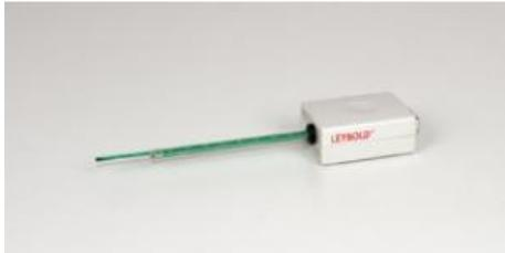
Pour mesurer la densité du flux magnétique en direction tangentielle ou axiale avec CASSY ( 524013 , 524006 , 524005W , 524018 ) ou l'instrument de mesure universel Physique ( 531835 ).
