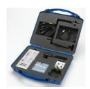
Ensemble de modules et capteurs CASSY pour l'acquisition des valeurs mesurées assistée par ordinateur sur des applications typiques de l'automobile au cours de la formation et du travail en atelier. Le matériel est rangé dans une valise à coque rigide.
