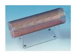
Pour mesurer l'intensité du champ magnétique en fonction du courant et du nombre de spires, pour démontrer que l'intensité du champ ne dépend pas de la surface de la bobine ainsi que pour les expériences quantitatives sur l'induction et les circuits électriques oscillants ; seulement pour les très basses tensions. Le corps de la bobine est en plexiglas et permet de voir à l'intérieur et à travers la bobine.
