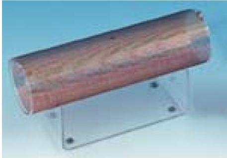
Pour mesurer l'intensité du champ magnétique en fonction du courant et du nombre de spires, pour démontrer que l'intensité du champ ne dépend pas de la surface de la bobine ainsi que pour les expériences quantitatives sur l'induction et les circuits électriques oscillants ; seulement pour les très basses tensions.
