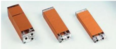
Pour mesurer la tension induite en fonction de la variation de la densité du flux magnétique. Les bobines ont un corps en plexiglas de différentes sections et avec un nombre de spires différent. Convient pour une utilisation dans les bobines de champ.
