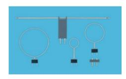
Pour mesurer l'induction magnétique sur des conducteurs rectilignes et annulaires parcourus par un courant (loi de Biot et Savart).
