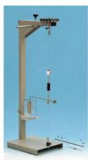
Pour mesurer de faibles couples, par ex. dans des expériences sur la loi de Coulomb, des forces agissant dans un champ électrique homogène et dans les champs magnétiques de conducteurs électriques, etc.
