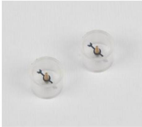
Pour le relevé point par point des lignes de champ ; les boussoles permettent également de visualiser par projection le spectre du champ magnétique. Aiguille aimantée sur pivot à frottement réduit, dans boîtier en plastique transparent.
