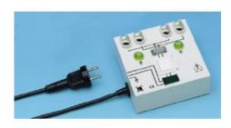
Pour brancher au réseau des montages ouverts réalisés en laboratoire à laide de câbles d'expérimentation de sécurité.
