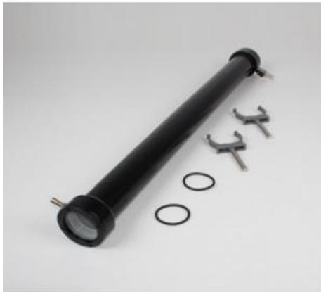
Pour la détermination exacte de l'indice de réfraction de l'eau par la mesure de la vitesse de la lumière selon le procédé de modulation ; avec deux robinets, deux colliers de serrage et deux tiges de fixation.
