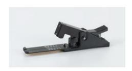
Ce coupe-fibres est idéal pour un usage quotidien et pour tous les cas où l'angle de coupe n'est pas critique. Grâce à une lame en céramique, la fibre est rayée puis cassée en pliant le loquet élastique. La fibre, dont le revêtement plastique a été retiré, est insérée de manière à ce que le revêtement plastique restant s'arrête au niveau de la butée et de la partie libre du support en caoutchouc.
