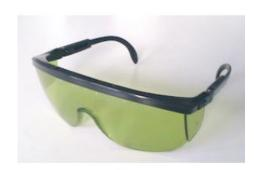
Lunettes de protection laser, absorbent la lumière de pompage de 808 nm, le rayonnement laser Nd:YAG de 1064 nm. Filtre vert avec ~56% de transmission de la lumière du jour.
