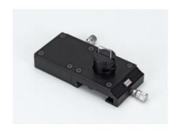
Le module de couplage de sortie est utilisé entre les deux collimateurs à fibre (474 191, 474 192). Une partie de la lumière traversant la plaque de verre est déviée selon la réflexion de Fresnel pour un angle d'incidence donné.
