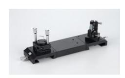
Traverse permettant de relier deux bancs d'optique parallèles. Pour la réalisation d'interféromètres, notamment de Mach-Zehnder.
