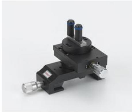
Support pour le positionnement d'une fibre optique sur le banc d'optique, avec possibilité d'ajustage.
