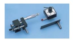
Avec vis micrométrique pour un déplacement précis du miroir plan (473 461). Pour la détermination en interférométrie de la longueur d'onde du faisceau laser. Sur tige.
