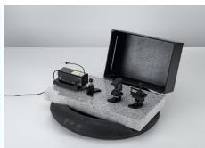
Pour le montage de différents dispositifs à interféromètres et pour la réalisation d'hologrammes de réflexion à lumière blanche et d'hologrammes de transmission.
