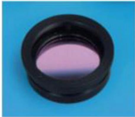
Filtre à bande extrêmement étroite pour la raie spectrale rouge du cadmium.
