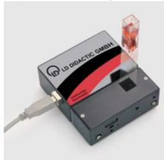
Spectrophotomètre compact pour l'enregistrement assisté par ordinateur de spectres d'émission et d'absorption, avec porte-cuve et source lumineuse, à entrée de lumière additionnelle par fibre optique librement déplaçable. À l'intérieur du spectromètre, la lumière est décomposée par une grille fixe et projetée sur une barrette CCD au silicium.
