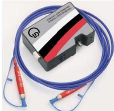
Spectromètre compact pour l'enregistrement assisté par ordinateur de spectres d'émission et d'absorption. La lumière entre par des fibres optiques mobiles.
