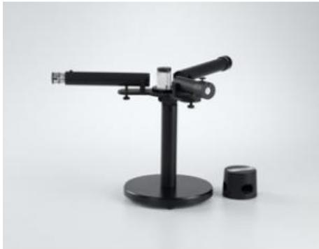
Pour observer et mesurer les spectres d'absorption et d'émission. Modèle réalisé d'après Kirchhoff et Bunsen :
