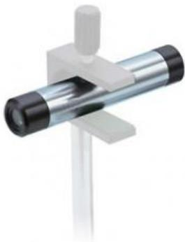
Pour l'observation libre des spectres, par ex. pour la mise en évidence des raies de Fraunhofer du spectre solaire.
