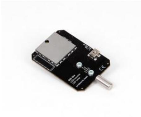
Lampe DEL pour des expériences d'étudiant sur l'optique de faisceau dans le Caisse de boîte à lumière (459093) et pour l'optique géométrique sur le rail métallique de précision (46082).
