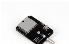
Lampe DEL pour des expériences d'étudiant sur l'optique de faisceau dans le Caisse de boîte à lumière (459093) et pour l'optique géométrique sur le rail métallique de précision (46082).
