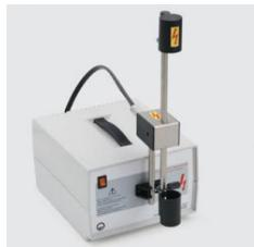
Avec douille sur tige munie d'un câble solidaire pour la fixation d'une lampe de Balmer (45113 ou 451 41) soit à l'alimentation, soit sur un banc d'optique.
