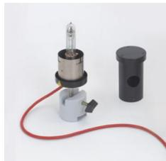
Pour la fixation et le branchement des lampes spectrales (451011 -111) à la bobine de self universelle ( 45130 ).
