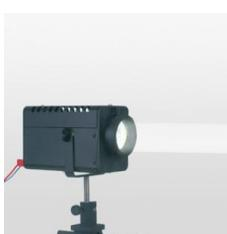
Du fait de la très faible extension de l'arc électrique et de sa forte luminance, cette source lumineuse convient particulièrement aux expériences d'optique ; avec ballast intégré dans boîtier avec lentille de condenseur sur tige.
