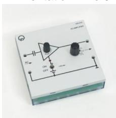
Amplificateur microphone sensible pour mettre en évidence les ondes ultrasonores.
