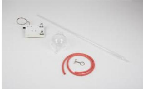
Pour mettre en évidence les ondes sonores stationnaires et mesurer la longueur d'onde dans l'air. Tube en verre vertical relié par un tuyau en caoutchouc à un vase de niveau. Lors de l'excitation par une source sonore à fréquence fixe, on observe des points de résonance pour des niveaux d'eau déterminés grâce auxquels on peut déduire la valeur de la longueur d'onde. Avec anneau-support réglable en hauteur pour le vase de niveau.
