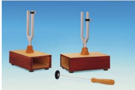
Pour produire la note-repère pour l'accord des orchestres, soit le « la », mettre en évidence la propagation du son dans l'air et réaliser des essais sur les battements.
