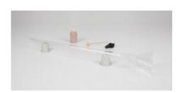
Pour enregistrer et mesurer les ondes sonores dans l'air. Tube en verre monté horizontalement dans lequel coulisse un piston. Une fine poudre de liège sert à indiquer la répartition des n?uds et des ventres résultant de l'excitation avec une source sonore intense. Livré avec supports, poudre de liège (692 88), sifflet (env. 2 400 Hz) et entonnoir en plastique.
