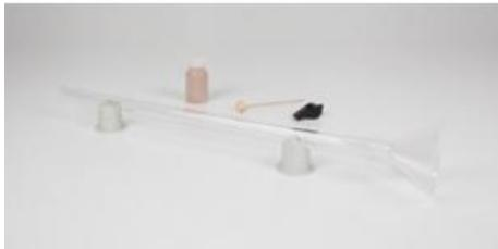
Pour enregistrer et mesurer les ondes sonores dans l'air. Tube en verre monté horizontalement dans lequel coulisse un piston. Une fine poudre de liège sert à indiquer la répartition des n?uds et des ventres résultant de l'excitation avec une source sonore intense. Livré avec supports, poudre de liège ( 692 88 ), sifflet (env. 2 400 Hz) et entonnoir en plastique.
