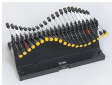
Pour illustrer la propagation, la réflexion, et la superposition d'ondes transversales. Le simulateur d'ondes est formé d'une chaîne de pendules doubles montés sur des lames, couplés par des cordes élastiques et oscillant sur un axe horizontal commun.
