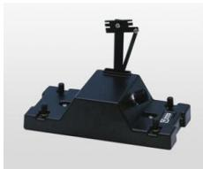
À coupler aux modules de base ( 40120 /21) afin de les exciter par un mouvement oscillatoire de fréquence variable. Doté d'un potentiomètre pour l'ajustage précis de la fréquence.
