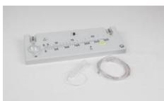
Manomètre à tube incliné pour mesurer les dépressions, les surpressions et les pressions différentielles d'un gaz en écoulement avec la sonde manométrique ( 373 13 ).
