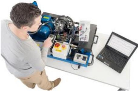
Cette unité est un système de climatisation automobile réelle, montée sur un support à des fins didactiques. Ce système permet d'étudier les principes du cycle de réfrigération et la fonction des composants du système. De plus, le banc comporte quatre interrupteurs permettant de réaliser des pannes réelles du système de climatisation d'automobile.
