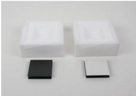
Pour étudier la variation de la température dans un capteur solaire en fonction du revêtement de surface de l'absorbeur, de l'isolation thermique et de la couverture.
