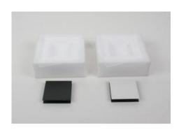
Pour étudier la variation de la température dans un capteur solaire en fonction du revêtement de surface de l'absorbeur, de l'isolation thermique et de la couverture.
