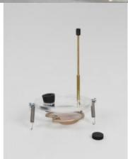
Avec un bouchon en caoutchouc percé pour le passage d'un thermomètre et du porte-échantillon
