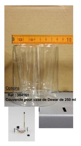
Avec un bouchon en caoutchouc percé pour le passage d'un thermomètre et du porte-échantillon A utiliser avec le vase de Dewar (386 48) pour déterminer des quantités de chaleur, notamment la capacité thermique massique d'un solide et d'un liquide ainsi que la chaleur latente, par ex. la chaleur de fusion et la chaleur dévaporation.
