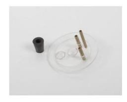
Composé d'un couvercle transparent avec possibilité de monter un filament chauffant (38422) ou un porte-échantillon (38423).
