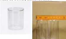
Calorimètre de démonstration pour la détermination des enthalpies de dissolution et de neutralisation. Récipient en verre à double paroi, sous vide, transparent et à fond plat pour la réalisation d'expériences sur l'agitateur magnétique.
