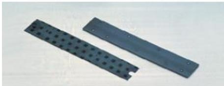
Pour mettre en évidence la dilatation thermique plus ou moins importante de différents métaux et du principe de fonctionnement d'un disjoncteur à bilame.
