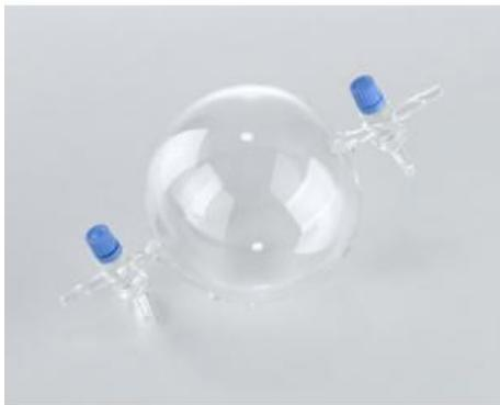
Pour déterminer la masse volumique de l'air en faisant le vide (vide grossier). Sphère en verre avec robinets en verre et olives de raccordement.
