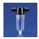
Ce filtre retient les goutelettes d'huile sous forme de brume ou d'aérosol. Filtrage des particules de lubrifiant entraînées avec l'air sortant Vidange par le biais d'une vis de décharge Taux de séparation > 99% Éléments de filtrage interchangeables (en fibres de verre).
