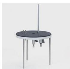
Platine pour la pompe à vide avec raccord latéral pour raccorder la pompe, robinet d'aération, disque d'étanchéité pour la cloche à vide ( 378562 et 378564 ), passage électrique et tige support.
