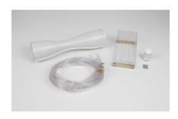
Pour l'étude de la pression statique à l'intérieur d'un tube à étranglement.
