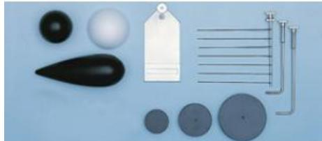
Corps de différentes formes et tailles à fixer de différentes façons pour déterminer la résistance aérodynamique avec la veine d'essais pour l'aérodynamique ( 37306 ) ou dans le tunnel aérodynamique ( 37312 ).
