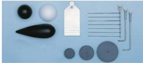
Corps de différentes formes et tailles à fixer de différentes façons pour déterminer la résistance aérodynamique avec la veine d'essais pour l'aérodynamique ( 37306 ) ou dans le tunnel aérodynamique ( 37312 ).
