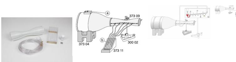
Pour l'étude de la pression statique à l'intérieur d'un tube à étranglement.
