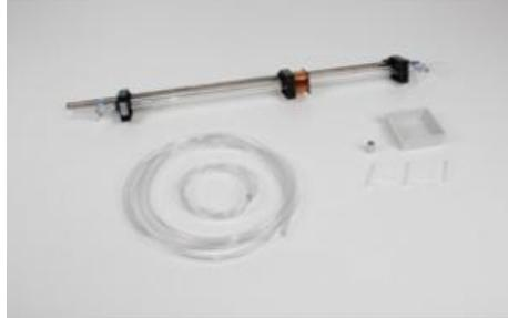
Permet de déduire l'équation d'état (transformation adiabatique), de déterminer le rapport  $c_p/c_V$  et le frottement intérieur des gaz ainsi que d'étudier la réponse en amplitude et en phase en cas de résonance. Se compose d'un tube en verre avec deux robinets à une voie, de deux pistons magnétiques, d'une bobine avec support, d'une tige à section hexagonale, de tuyaux en PVC et de raccords pour tuyaux.
