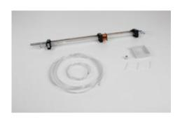
Permet de déduire l'équation d'état (transformation adiabatique), de déterminer le rapport c p /c V et le frottement intérieur des gaz ainsi que d'étudier la réponse en amplitude et en phase en cas de résonance. Se compose d'un tube en verre avec deux robinets à une voie, de deux pistons magnétiques, d'une bobine avec support, d'une tige à section hexagonale, de tuyaux en PVC et de raccords pour tuyaux.
