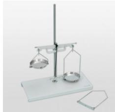
Convient particulièrement pour la détermination de la densité, la démonstration du principe d'Archimède et le pesage de l'air contenu dans une sphère à 2 robinets (37907).
