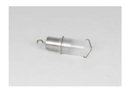
Pour démontrer le principe d'Archimède. Récipient cylindrique avec anse et crochet dans lequel s'emboîte exactement un cylindre creux avec anneau.
